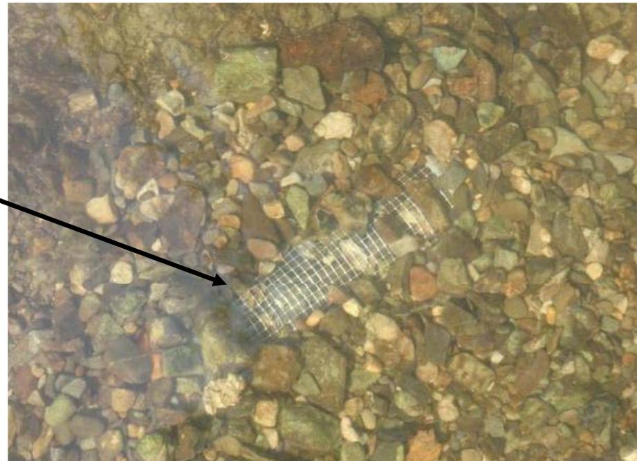
➡ Analyse du taux de remplissage du piège et de la granulométrie des particules piégées
